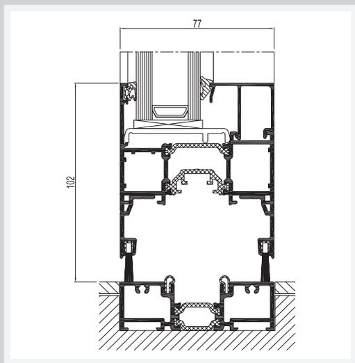
**CF77** è il sistema scorrevole richiudibile a libro che combina alti livelli di isolamento termico con la massima possibilità di apertura e trasparenza.
